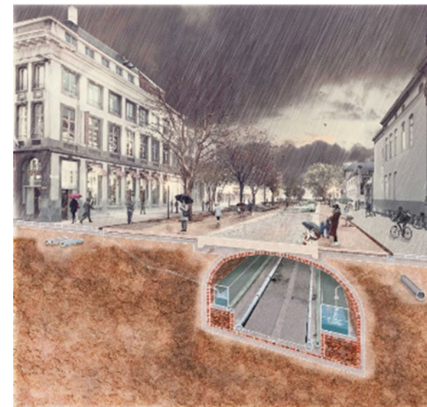
Figur 45: Hur det blå-gröna lösningarna samverkar med de grå lösningarna (De Urbanisten u.å.a).
